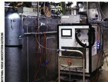
Το επιστημονικό όργανο PTR-TOF-MS ήταν η άκρως ευαίσθητη «μύτη» που χρησιμοποιούσαν οι ερευνητές προκειμένου να ταυτοποιήσουν όλους τους τύπους αερίων ρύπων εντός των γραφείων
