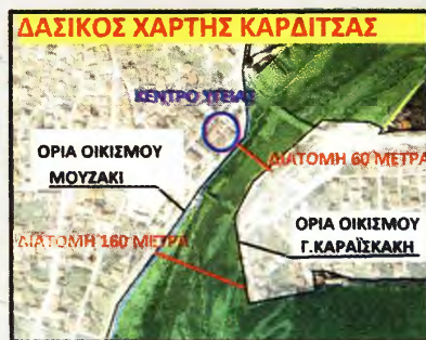
Στον ορθοφωτοχάρτη του κτηματολογίου 2015-2016 βλέπουμε ότι η διατομή του ποταμού στο συγκεκριμένο σημείο έχει στενέψει με επικωματώσεις και μπαζώματα από 16 μέτρα στα 60 μέτρα περίπου.
